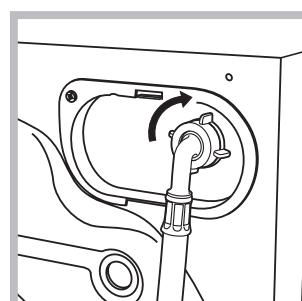
2. Pripojte prítokovú hadicu k práčke, jej zaskrutkováním k príslušnej prípojke na vodu, umiestennej vpravo hore (vid' obrázok).
